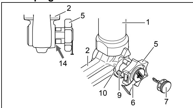
Position déverrouillée, accouplement non monté
